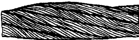
Рисунок 13. Местное увеличение диаметра каната
