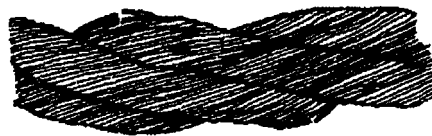
Рисунок 1. Обрывы и смещения проволок каната крестовой свивки
